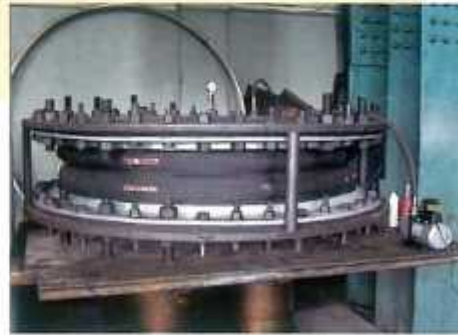
تست خلاء لرزه گیر لاستیکی فلکسور سایز: ۶۴ اینچ نوع دو قوس پروژه: نیروگاه نکا
