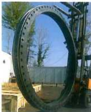
بزرگترین لرزه‌گیر لاستیکی تولید شده در خاورمیانه با دهانه داخلی ۲۸۰۰ میلیمتر
